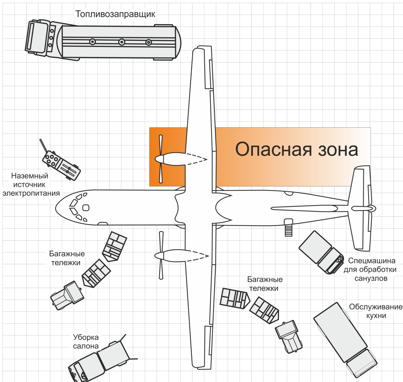
Рис. П.5 - Схема размещения спецтранспорта (продолжение) При работающем правом двигателе в режиме «HOTEL MODE»
