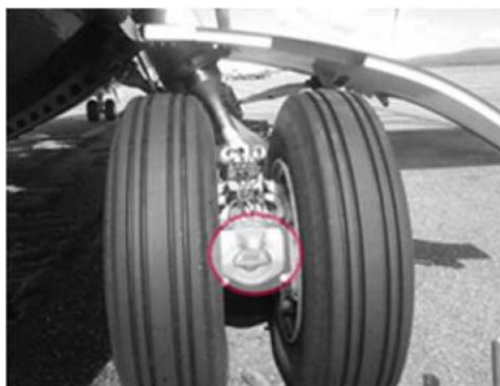
Рис. П.12 - Расположение точек заземления ВС
